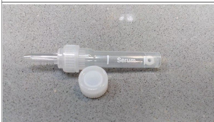
Plastová zkumavka s aktivátorem srážení Sarstedt Multivette, objem 600 ul, bílý uzávěr.
